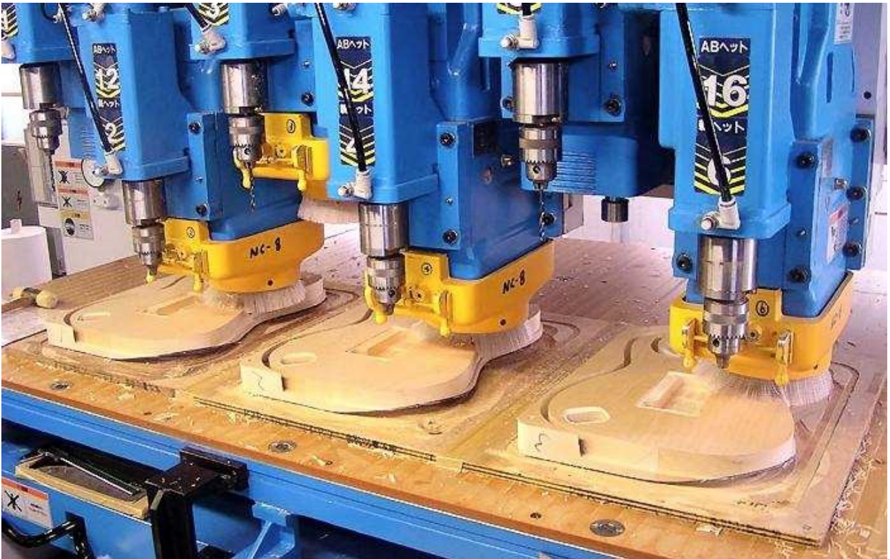
Bild 13: Moderne CNC-Fräsen zur Herstellung des Korpus
